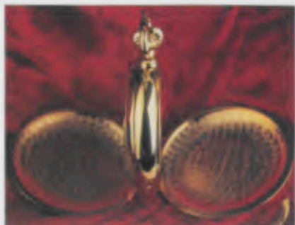
Seitenansicht: Oben am linken Gehäuserand erkennt man die Nase der stählernen Sprungdeckelfeder. Bei Druck auf den Kronenknopf wird diese hinter den Glasrand geschoben und der Deckel springt auf.
