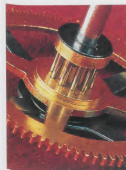
Hohltrieb aus einer Großuhr.
