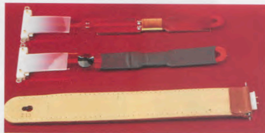
Drei Fertigungsstadien eines Funkuhr-Armbandes. Oben die Antenne mit umwickelten Plättchen-Schichten. Mitte: Da die Uhren wassergeschützt sind, wird die Antenne mit Schrumpffolie umhüllt. Unten das fertige Band mit den Kontakten zum Gehäuse.
