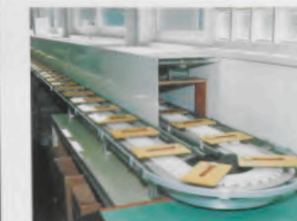
Teststrecke „Time-Tunnel“: Armband-Funkuhren empfangen hier von einem Mini-Sender eine falsche Zeit und müssen sich außerhalb der Abschirmung wieder auf DCF 77 einstellen.
