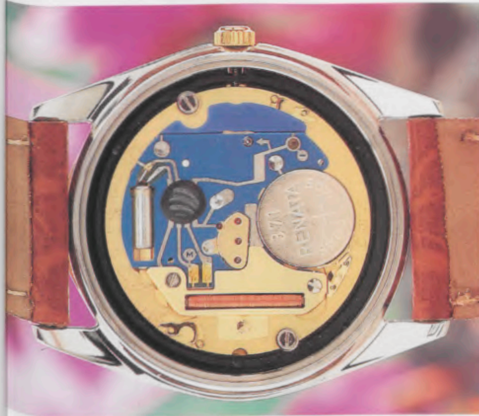
In der Tissot-Herrenuhr sorgt ein ETA-Werk, Kaliber 955.112, für genaue Zeitangabe.
