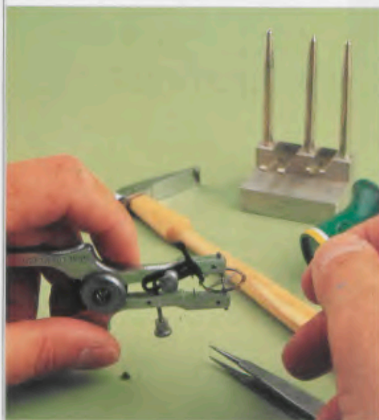
Dieses Bild zeigt den eigentlichen Einsatz des Rundlaufzirkels: Die Unruh wird gedreht – läuft sie flach, verändert sich der Abstand zum heruntergeklappten Bügel nicht, und umgekehrt.
