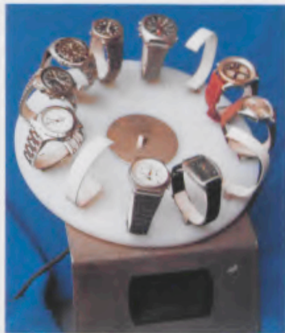
Uhrenbeweger von Leser Pajenkamp. Die Scheibe hat einen Durchmesser von 28 cm, die Schräglage beträgt 45 Grad.
