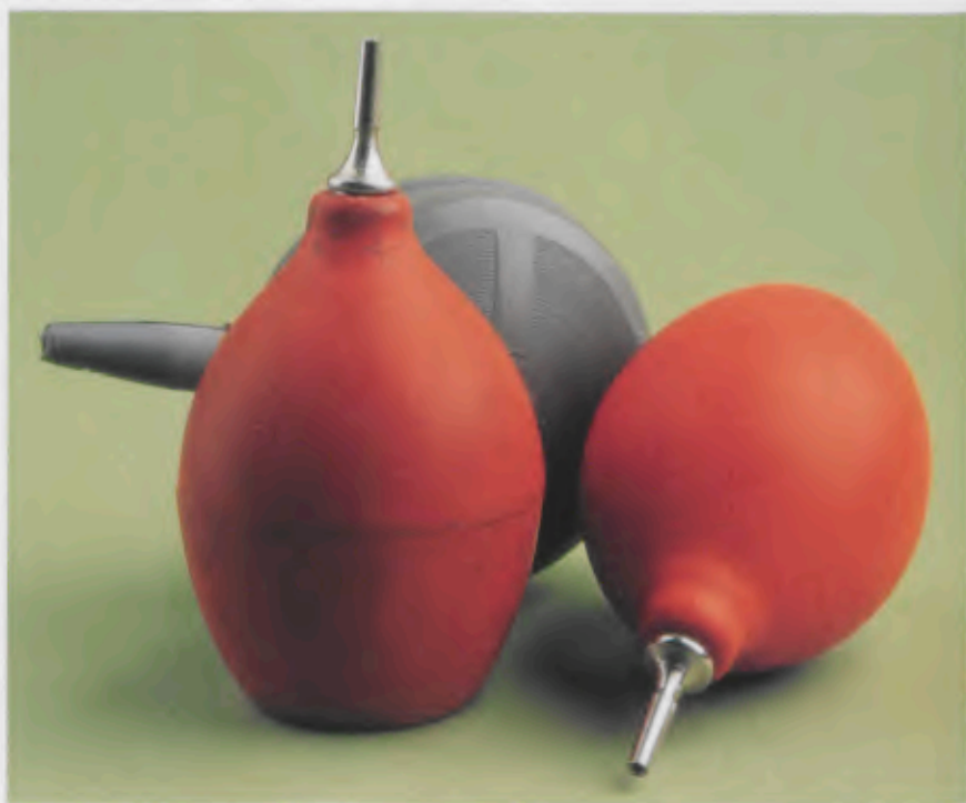
Staubbläser für Uhrmacher haben auf ihrer Rückseite ein Ventil, durch das Luft eingesogen wird. Würde die Luft von vorn eingesogen, könnte es leicht passieren, daß der Staubbläser unbeabsichtigt zum Staubsauger wird und kleine Uhrenteilchen auf Nimmerwiedersich verschwinden läßt.
