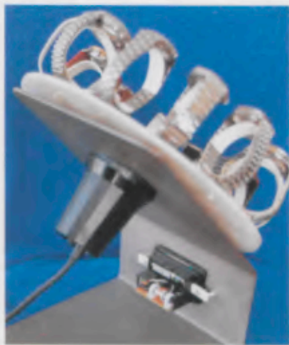
Uhrenbeweger von hinten. Unten das Funkuhrwerk; der Standsockel hat eine Tiefe von 23 cm.
