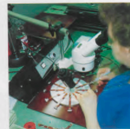
Funkuhr-Armband: Hier wird eine Lötverbindung zwischen Leiterbahn und der Wicklung der Antenne hergestellt.
