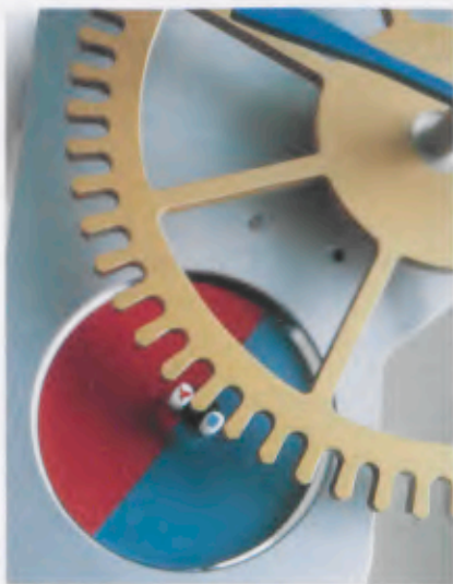
Hier hat der Motor schon einige Schritte getan. Bei jedem Schritt wird das Zahnrad durch die beiden Stifte auf dem Rotor um einen Zahn weitergedreht.
