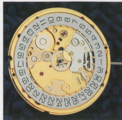
Das ETA-Kaliber 2892-2 wird von sehr vielen Uhrenherstellern verwendet. Hier einmal die selten gezeigte Zifferblattseite. Das Stundenrad ist abgenommen.
