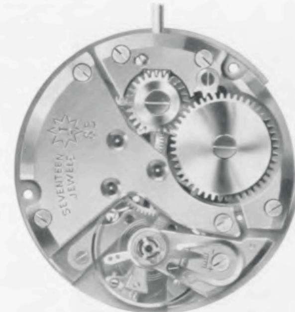
In fünf Lagen und in verschiedenen Temperaturen ausreguliert und amtlich geprüft. Spiralweiser mit erweiterungsfähigem Regulierbereich (DBP. angem.) und Feinstellschraube. Werk und Gehäuse nummeriert. Platinen rotvergoldet mit feinem Rundschliff, Abschrägung poliert, facettierte Sperrräder, hochwertige Beryllium-Bronze-Unruh mit Nivarox-Spiralfeder, bruchgeschützte Spezialzugfeder. Original Junghans-Stoßsicherung (DBP. und Auslandspatente).
