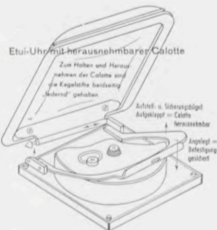
Herausnehmbare Calotte Detachable Boudoir clock Calotte à enlever Reloj destacable del estuche
