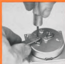
Abb. 4 Diese Abbildung zeigt das Hilfswerkzeug in seiner Funktion bei den kleinen Junghans-Weckern.
