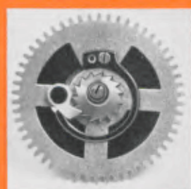
Abb. 5 Die Befestigung der Sperrfeder durch eine Schraube erlaubt das mühelose Auswechseln einer zerbrochenen Sperrfeder ohne Demontage des Werkes.
