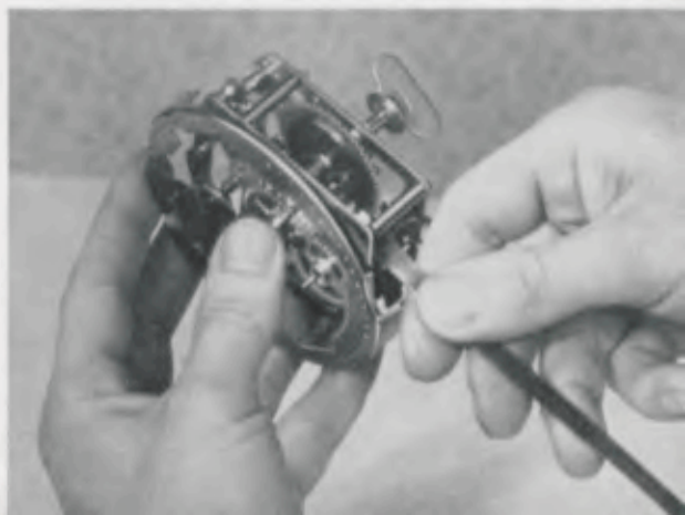
Abb. 1 Die Junghans-Reparaturfeder wird in ihrer ursprünglichen, langgezogenen Stahlbandform ohne Werkdemonage innen am Gestellfeiler eingeführt und an dem Haken der Federwelle eingehängt.
