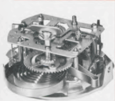
Abb. 2 Nach Wiederauflagen der Sperrfeder wird der Aufzugschlüssel so weit gedreht, bis sich die Schlaufe am Federende um den Platinenpfeiler legt.
