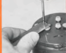
Abb. 2 So einfach ist bei einem Bruch der Sperrfeder das Abschrauben des Schlüssels mit Hilfe des leicht selbst herzustellenden Hilfswerkzeuges.
