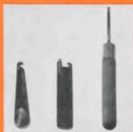
Abb. 3 Wenn Sie die nebenstehenden Abbildungen um das vierfache vergrößern, haben Sie eine genaue Vorlage zur Anfertigung der Hilfswerkzeuge für das Abschrauben des Schlüssels bei Junghans-Weckerwerken.
