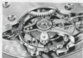
Uhr mit Feinregulierung des Junghans-Chronometers
