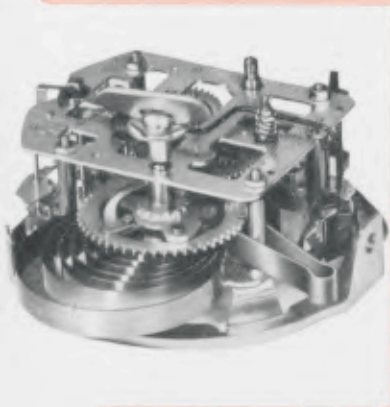
Abb. 2 Nach Wiederauflegen der Sperrfeder wird der Aufzugschlüssel so weit gedreht, bis sich die Schlaufe am Federende um den Platinenpfeiler legt.
