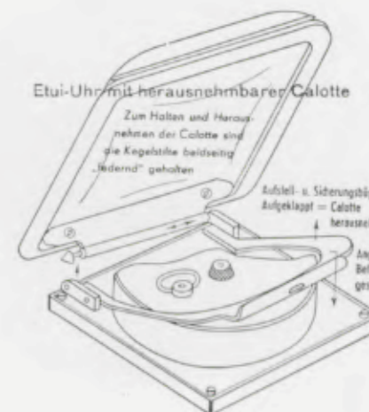
Herausnehmbare Calotte Detachable Boudoir clock Calotte à enlever Reloj destacable del estuche
