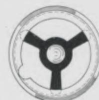
Decksteinfeder, herausnehmbar durch Drehen bis zum Einschnitt
