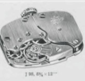
ANKERWERK J 98,  $8\frac{3}{4} \times 12''$ , **15 Steine**, mit gefrästen Hartmessing-Platinen, getrennte Federhaus- und Radbrücke, Palettengang, massive Unruhbrücke, stoßgeschützt (Deutsches Patent), großes Federhaus, neuartiges Gesperr, seitlich abspinnbar (Deutsches Patent angemeldet). Die günstige Außenform des Gehästs ermöglicht die Verwendung eleganter Gehäuse.
