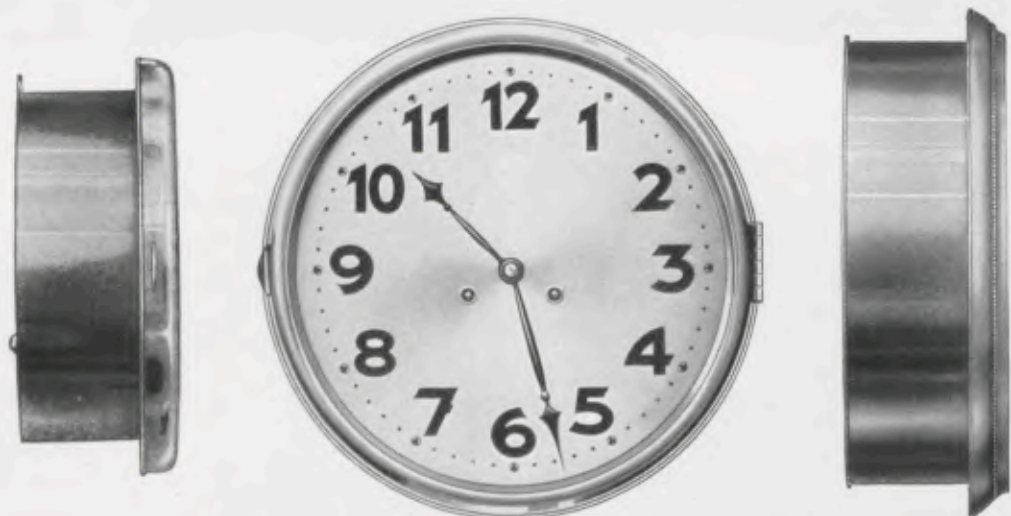
14 Tag Pendelgehwerk, Chromlunette, Silberblatt Minutenkreis-Durchmesser 225 mm Lunetten-Durchmesser 275 mm, Hintergehäuse- Durchmesser 232 mm, Hintergehäuse-Tiefe 80 mm
