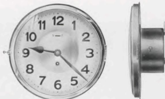
8 Tag Ankergehwerk mit 7 Steinen, Chromlunette, Silberblatt Minutenkreis-Durchmesser 190 mm, Lunetten-Durchmesser 225 mm Hintergehäuse-Durchmesser 107 mm, Hintergehäuse-Tiefe 55 mm
