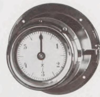
Telefonuhr Reichspost-Modell Nr. 841/20 Fabrikat Junghans, 6 Minuten Gangdauer, Glockensignal bei 3 und 6 Minuten, Hebel zur Gangunterbrechung, Messinggeh. braun oxydiert, gegen Staub gesichert Serie 8711 RM 10.—
