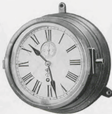
461 Messing poliert, vernickelt oder schwarz oxydiert, sehr solides Metallgehäuse, 15,5 cm geätztes Silber- zifferblatt, 8 Tag-Gehwerk, ff. Ankergang
