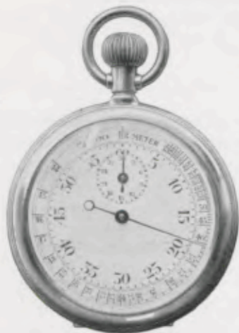
108.3 Stoppuhr und Geschwindigkeitsmesser mit 1/5 Sekunden-Einteilung und Skala zur direkten Ablesung der Durchschnittsgeschwindigkeit in Kilometern pro Stunde bei 200 m Abstoppung
