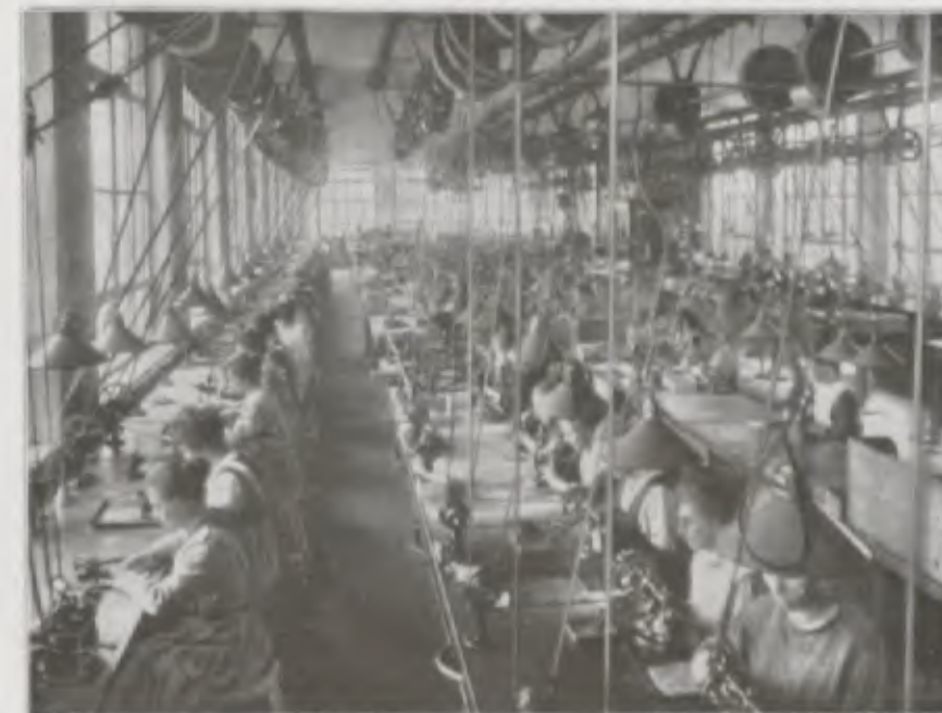
Ankers und Uprubes Fabrication Manufacture of pallets and balances Fabrication des ancrés et balances
