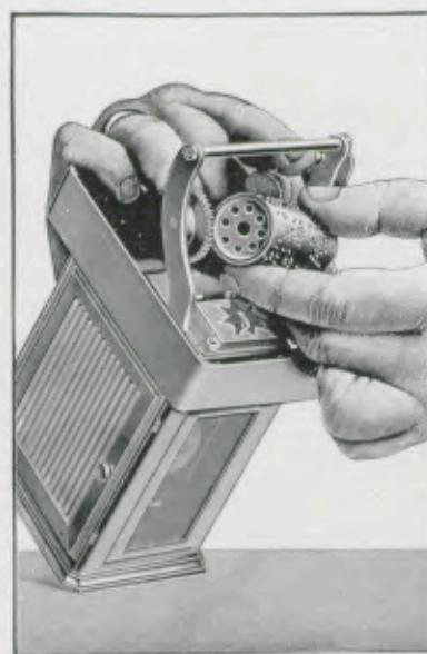
Es wird eine neue Walze eingelegt (siehe die Stellung beider Hände.)
