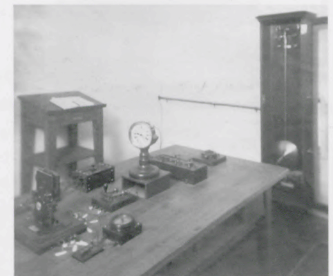
Zeitdienstanlage bei Junghans um 1910 mit Präzisionspendeluhr und Nebenuhr (Sekundenschläger)
