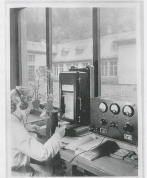
Die elektrische Zeitwaage, eine sehr hochelegante Apparatur zur raschen Kontrolle der Ganggenauigkeit von Junghans-Armband- und Taschenuhren
